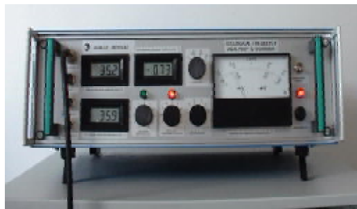
Fig. A2:2. A precision 8.0 - 12.0 uM spectrum Radiometric Scanner Apparatus.
